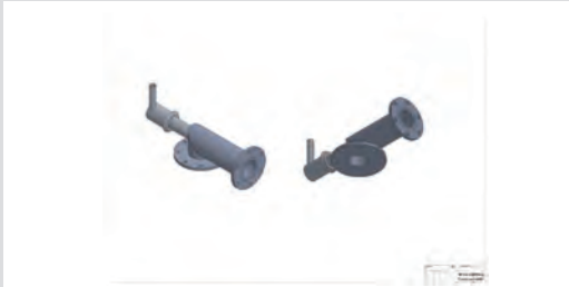
플라즈마 화염을 선형 화염으로 변화시키는 Elbow Nozzle ▲
