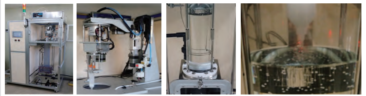
증식재 페블 성형 자동화 장치, 페블 제조 능력(Li 2 TiO 3 ) : 50 Kg/year ▲
