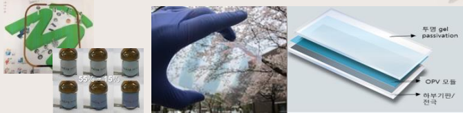
OPV 모듈의 유연성/투광성 제어용 상/하부 전극 소재 및 습식 보호막 소재
